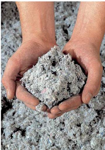
ISOCELL es un **aislante térmico** de fibras de celulosa, fabricado **mediante un óptimo proceso de reciclaje a partir de papel de periódico**. Es decir, el material base de ISOCELL es la madera, cuyas excelentes cualidades ya se conocen desde hace milenios. ISOCELL se fabrica en Austria y Bélgica, en una de las plantas más modernas de Europa.
